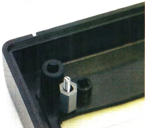
Fig.15 Particolare del montaggio del distanziatore plastico sulla vite.
