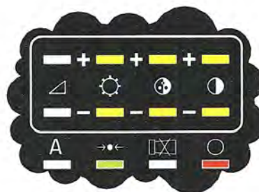
Fig.4 Per variare la luminosità delle lampade LP1-LP2-LP3 premete i tasti +/- che nel disegno appaiono di colore Giallo.
