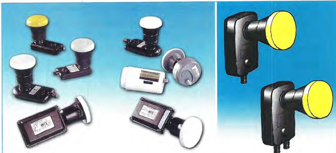
Fig.10 Sul braccio di ogni parabola troveremo sempre fissato un convertitore LNB (vedi fig.3), che ha il compito di amplificare tutte le frequenze da 10,75 a 12,7 GHz e di convertirle sulle frequenze di 950-1.750 MHz. Per poter ricevere tutte le emittenti con polarizzazione Verticale e Horizontale occorre modificare la tensione di alimentazione dell'LNB (leggere il testo). A questo provvederà il Decoder.
