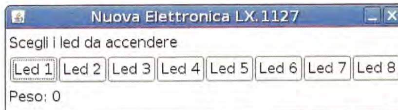
Fig.4 Se il vostro sistema operativo è Linux, il programma in java GuiLX1127 sarà lo stesso e la finestra che visualizzerete sarà questa. Notate come la finestra creata sia formata, per tutti i sistemi operativi, da 8 bottoni e due label di descrizione.
