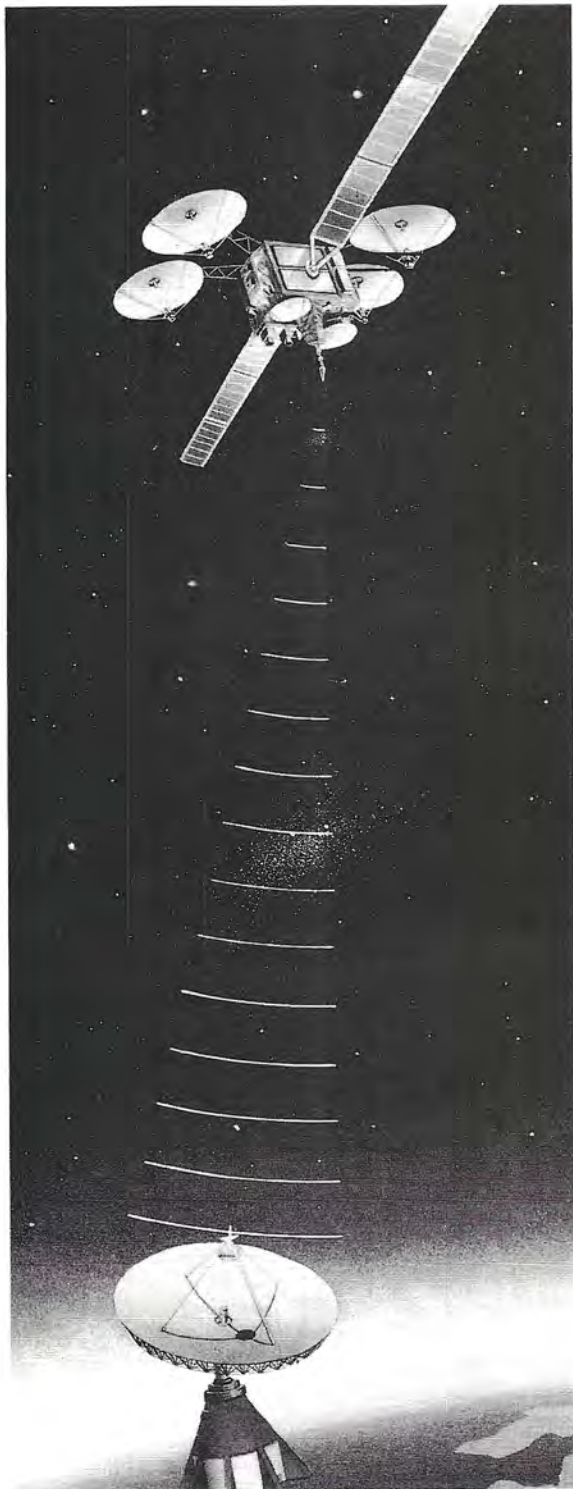
Fig.4 Su ogni satellite sono collocati dei ricevitori che provvedono a captare i programmi TV che le varie emittenti poste a terra trasmettono verso il satellite.
